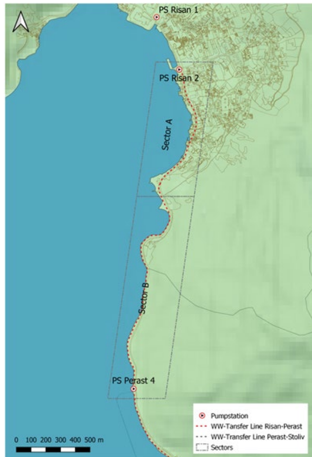
Slika 3.1. Trasa kanalizacione tranzitne linije Risan-Perast
