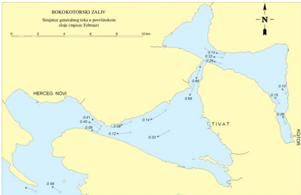
Slika 2.7. Strujnice generalnog toka u površinskom sloju za mjesec februar
